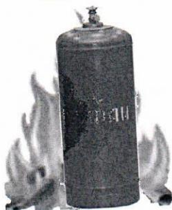
Баллон в очаге пожара, пламя воздействует на его стенки
