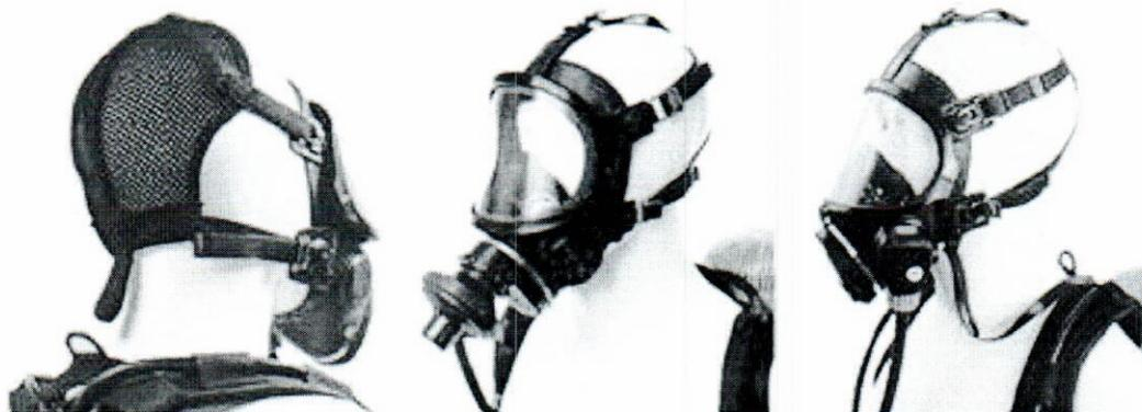
В соответствии с ГОСТ Р 53257-2009 маски обладают повышенной теплостойкостью, выдерживают воздействие открытого пламени в течение 5с и теплового потока  $8,5\text{кВт/м}^2$  в течение 20 мин.
